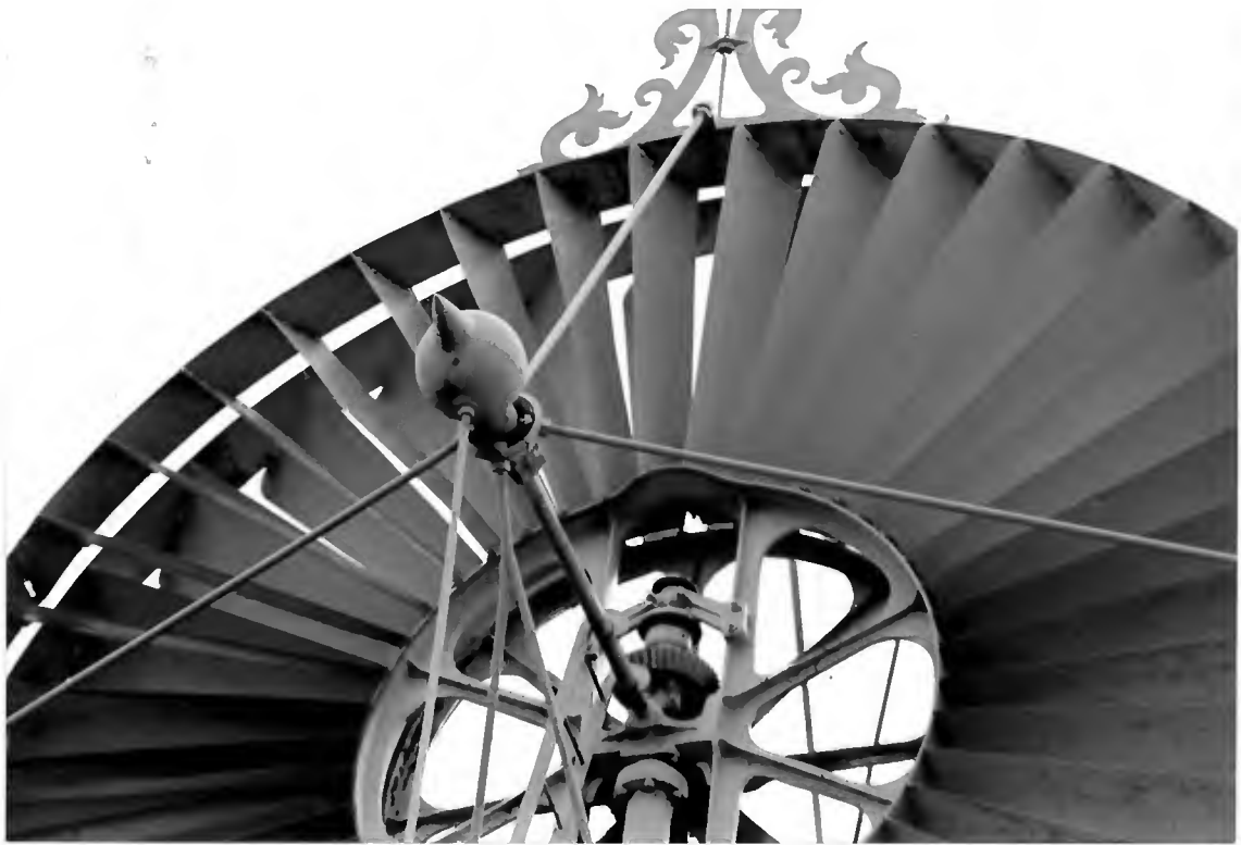
The Eolienne Bolée wind engine at Epuisay
